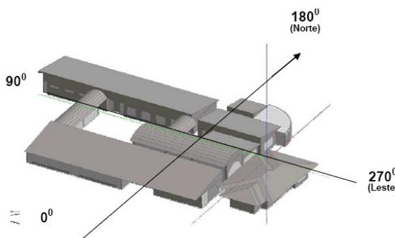
A Figura a seguir ilustra os resultados da simulação para as três capitais citadas. Como se pode observar, para qualquer localização geográfica, as orientações do edifício entre 60 e 90° (fundos para Oeste) e entre 240 e 270° (frente para Leste) acarretam as menores cargas térmicas, devendo assim ser preferidas.
